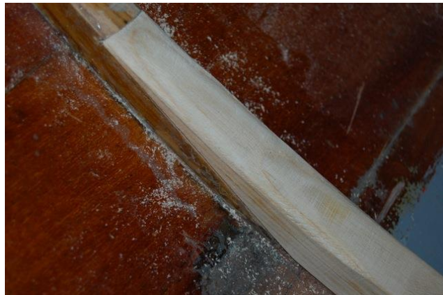
Grovpassning av det nya limmade spantet. Finputsning väntar
