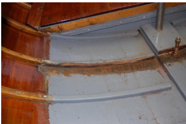
Alla fyra spant var knäckta på detta viset bakom bottenstockarna
