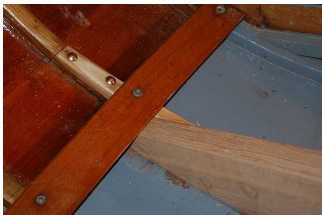
Spantet nitat och klart. Bottenstocken också färdig. Lite finputsning och linolja så är jobbet gjort
